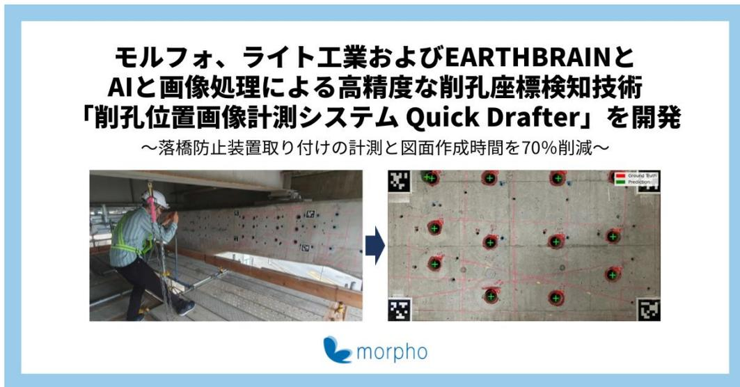
本システムは、落橋防止装置施工の工程中、コンクリート削孔を実施した際の削孔位置をスマートフォンのカメラで撮影することで、自動で孔位置の計測から図面化する技術です。本システムを使用することで、施工管理業務の負担軽減や時間外労働削減が可能となります。
