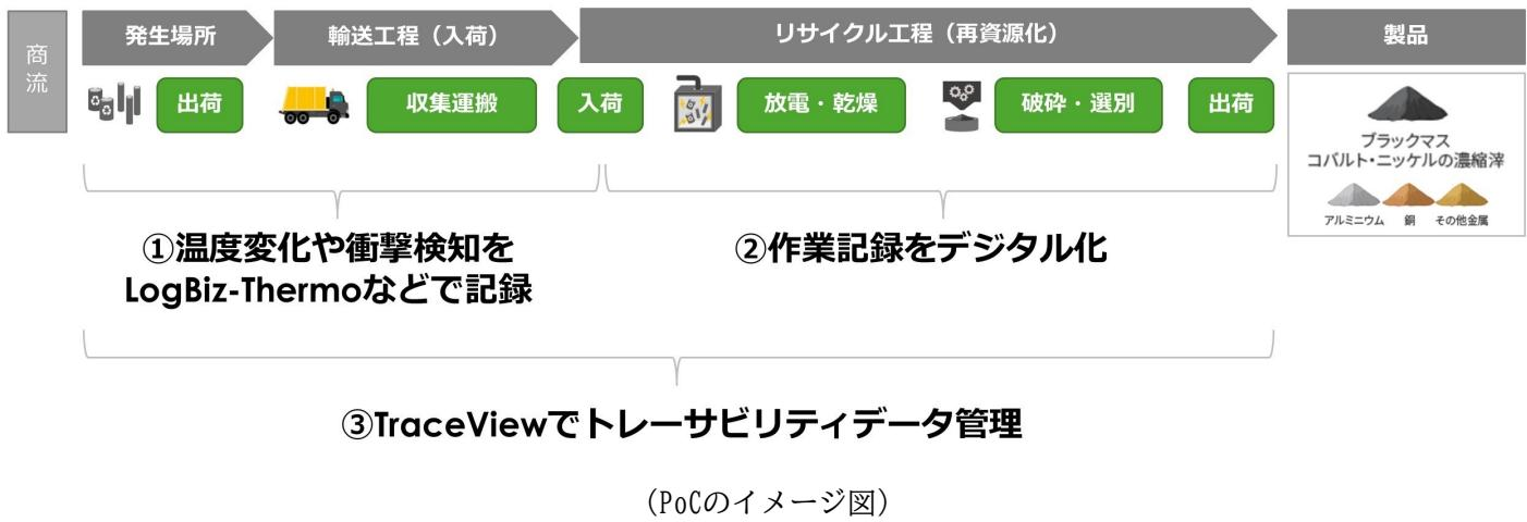
具体的には、使用済みLIBの入ったドラム缶にRFID温度ロガータグ（以下「タグ」）と、衝撃データロガーを貼り付けます。各ロガーの機能を有効にし、ロガーおよびIDを付与したタグとして貼り付けて出荷。輸送中は温度ロガーと衝撃データロガーでログを継続的に記録して状態をモニタリングします。
