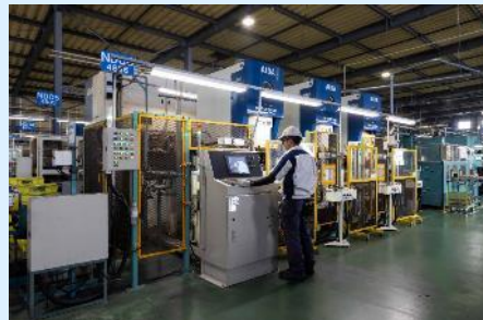
当社独自工法の傘中空バルブのネックング工程
