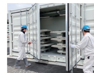
CO 2 -SUICOM 炭酸化養生槽のイメージ
