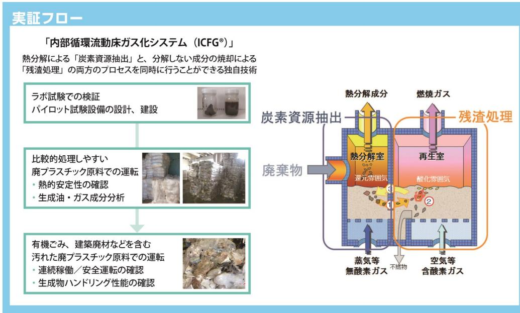
本事業では荏原環境プラントが独自技術である「ICFG®内部循環流動床ガス化システム」の実証プラントを千葉県内に建設し、1日当たり約1トンの廃プラスチック類を熱分解することで生成される油やガスがプラスチックの製造原料として活用可能であることを実証します。
