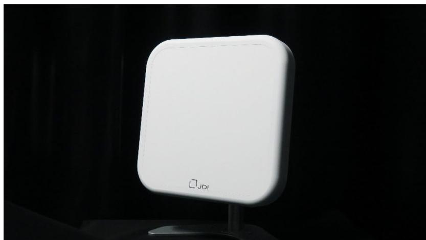
液晶メタサーフェス反射板は、当社が培ってきた液晶技術を電波の世界に応用した5G（第5世代移動通信システム）向け通信デバイスです。大容量通信が可能なミリ波（30～300GHzの周波数の電波）を任意の方向に反射することで、ビル影など電波の届きにくいエリアでの通信環境を改善します。
