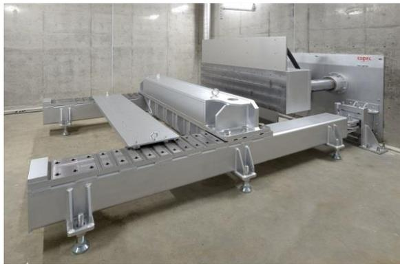
圧壊試験機(第1安全試験室)
