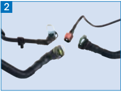
樹脂燃料配管
