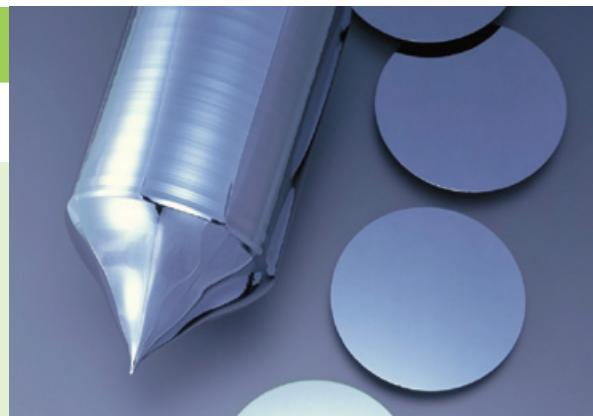
単結晶シリコンのインゴットと300mmシリコンウエハーススマートフォン、パソコンなどの電子機器、データセンターや自動車などに使われる半導体デバイスの基板材料として利用されています。
