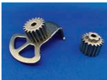
プレス部品とのカシメ接合技術の開発 によるアクチュエータ部品の焼結化
