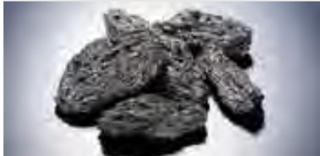
電炉用電極向けニードルコークス
