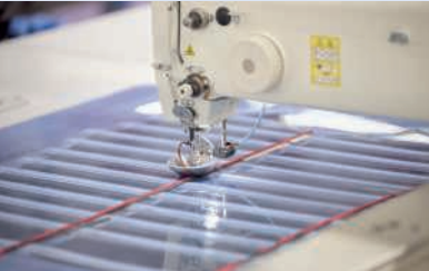
自動で縫製するマシン。人の手がそのサポートを行います。
