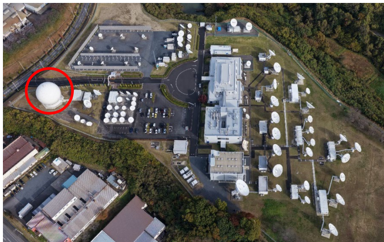
（左側）茨城ネットワーク管制センター（Space Port East：SPE）：「アルテミス II」における一方向ドップラー測定で地球周回軌道および地球-月までの空間からの信号を受信する拠点の一つ。 （右側）アンテナを覆う保護構造“レドーム”付アンテナ設備：左側赤丸箇所を地上から撮影。
