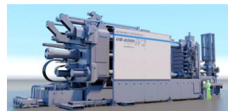
国内初のギガキャスト用マシン UBE6500iV2
