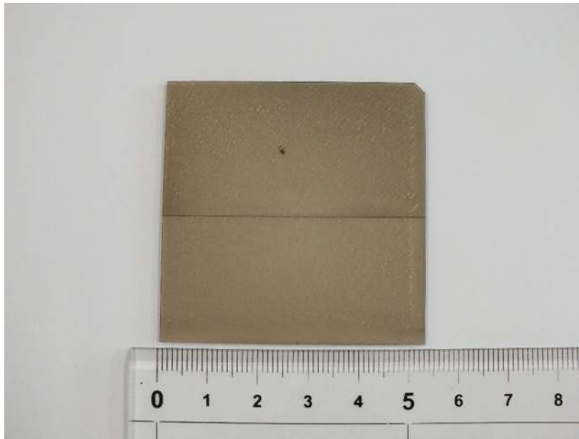
写真：研磨が完了した53×53mmのモザイク結晶
