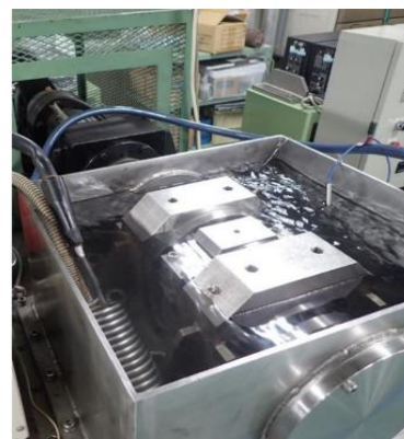
実際の使用環境を想定し、海水を使った性能試験の様子＝神奈川県藤沢市のオイレス工業 藤沢事業場
