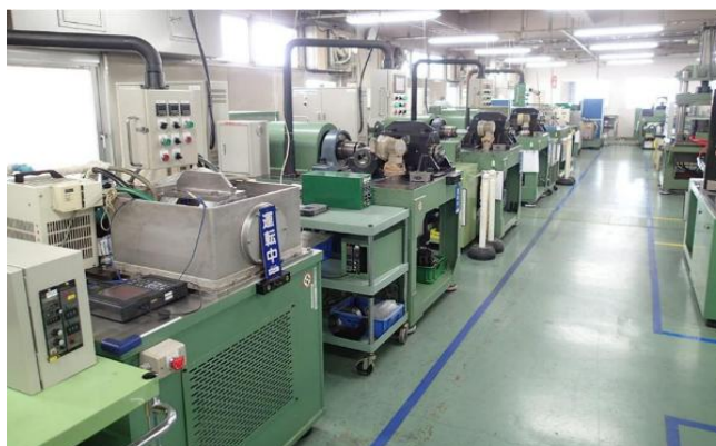
実際の使用環境を想定し、海水を使った性能試験の様子＝神奈川県藤沢市のオイレス工業 藤沢事業場
