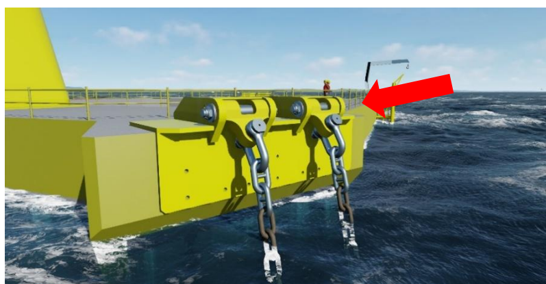
海面の基礎と係留チェーンの接続部分に使用されている「ファイバーフロン GH」（出典：Région Occitanie / Pyrénées）
