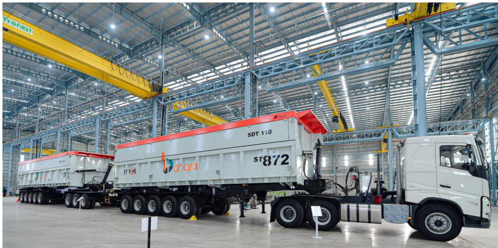
超大型サイドダンプフルトレーラ(ボデー容積：前 110 m 3 ・後 125 m 3 )
