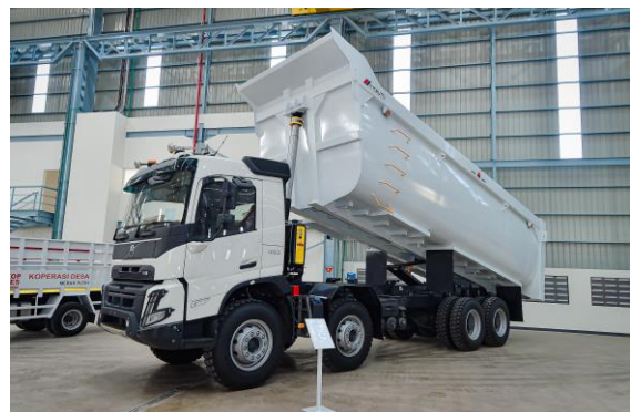
大型リアダンプトラック(ボデー容積：45 m 3 )
