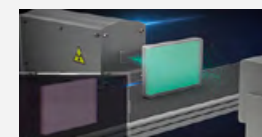
Lib製造工程内検査: リチウムイオン電池(LiB)の内部・外部を検査(図はX線による内部検査)
