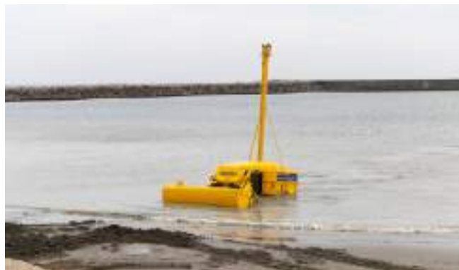
港湾で実証実験中の水中施工ロボットのコンセプトマシン
